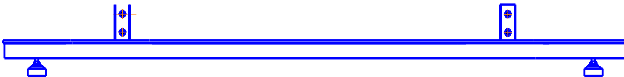
Рис.1 Весы с приваренными крепежными стойками для ограждений
