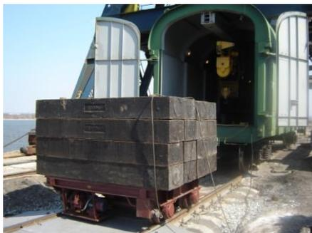
Вагонные весы Вектор-4 просты в монтаже, не требуют изготовления заливного бетонного фундамента, что сокращает время и стоимость установки оборудования. Грузоприемное устройство вагонных динамических весов состоит из одной платформы. В качестве измерительных элементов весов используются тензорезисторные датчики, обеспечивающие высокую точность измерений и надежность работы весов даже в неблагоприятных условиях эксплуатации.
