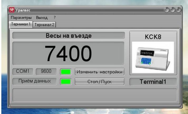
Основное окно имеет одну или несколько вкладок по количеству установленных (подключенных) терминалов. На каждой вкладке отображаются данные соответствующего терминала. Заголовки вкладок могут именоваться порядковыми номерами терминалов либо их описаниями. Настройки этих функций – в меню «настройки программы».
